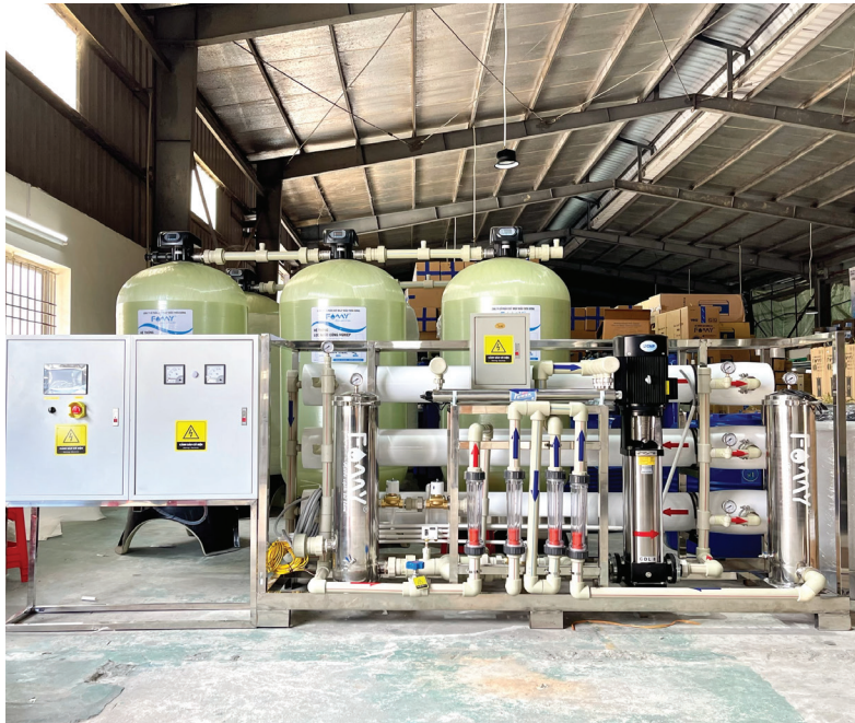
Hệ thống lọc nước RO công suất lớn cho phục vụ cho toàn bộ nhân dân và cán bộ chiến sĩ huyện đảo Bạch Long Vĩ
